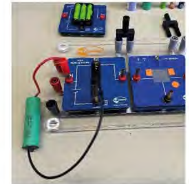
Versuchsaufbau zur Messung der Wirkungsgradkette von Elektrolyseur und Brennstoffzelle
